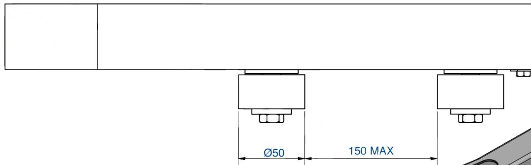
Guide supérieur réglable a sceller pour porte roulant sur rail au sol , 2 olives montées sur cage à rouleaux
