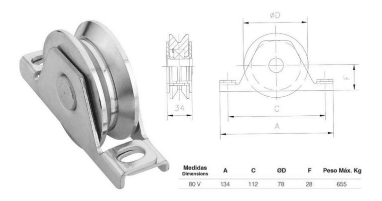
Roue en inox 303, et chape en inox 304L Roulement à billes inox 6204 2RS
